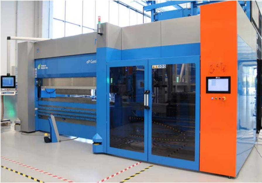
**eP Genius, pressopiegatrice con cambio utensili automatico.**
